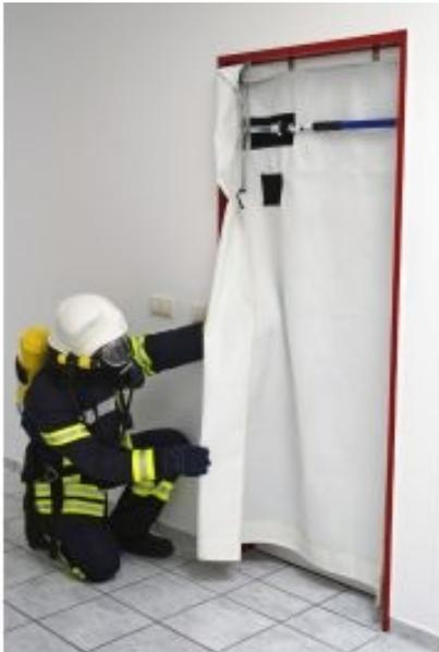
L'installation de l'obturbateur de fumée est indépendante du matériau du cadre de porte et convient pour des largeurs de porte de 90 à 150 cm. Le matériel spécial en fibre de verre est très stable et présente une résistance élevée à la température (jusqu'à 600°C). Il est étanche à la saleté et à l'eau et donc facile à nettoyer. Le RSS peut être transporté dans un sac de transport ou dans un panier tubulaire.
