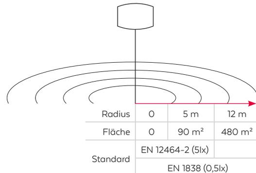
Wie man die Zeichnung liest: innerhalb eines Radius von 12 m, entspricht einer Fläche von 480 m<sup>2</sup>, erfüllen die Lichtballons die Anforderungen der EN1838.
