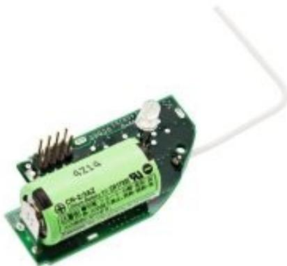
Löst ein funkvernetzter Melder Alarm aus, sendet das Funkmodul entsprechende Daten an alle mit ihm durch Hauscodierung verbundenen Geräte. Innerhalb kürzester Zeit befinden sich alle Geräte im
