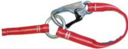
Die Selbstsicherungsschlinge ist die ideale und sichere Ergänzung für die PSA. Sie besteht aus stabilem, 78 cm langem Gurtband aus PAMaterial. Das Ende der Schlinge wird einfach per Ankerstich im Gurt eingebunden. Die Schlinge wird um die Struktur gelegt und mit dem Doppelhebelkarabiner wieder in den Gurt eingeklinkt. Durch den eingenähten Stahlring kann die Schlinge auch verkürzt angewendet werden. Sicherheit und Übersichtlichkeit des Systems erhöhen sich damit weiter!
