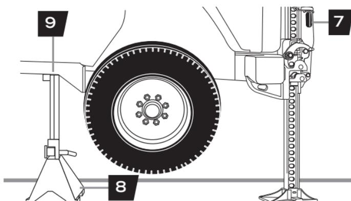
5. Nehmen Sie den Handgriff oder die Handgriffhalterung mit der Hand und heben Sie den Hubmechanismus, bis die große bewegliche Spannbacke vollständig und sicher unter der Last ist.
