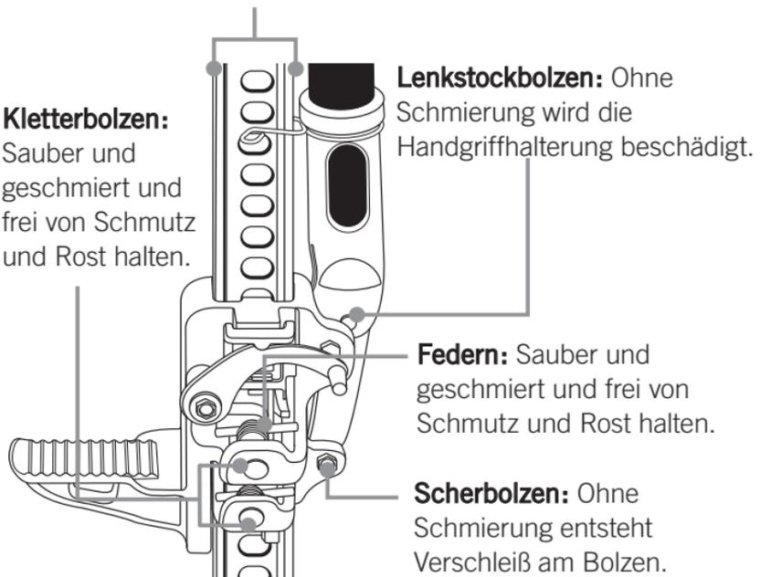
**Wichtig!** Verwenden Sie kein Motoröl oder Fett zum Schmieren des Fahrzeughebers.
