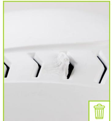
Außenschale mit verformtem Lüftungsloch
