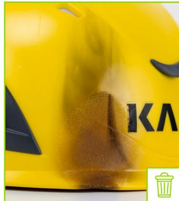
Außenschale mit Flammenbrandspuren
