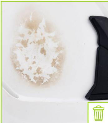
Außenschale mit Spuren einer chemischen Substanz
