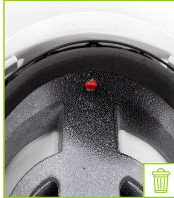
Innenschale mit Flammenbrandspuren
