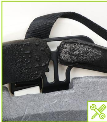
Füllung mit Flammenbrandspuren
