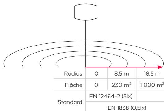
Wie man die Zeichnung liest: innerhalb eines Radius von 18,5 m, entspricht einer Fläche von 1 000 m<sup>2</sup>, erfüllen die Lichtballons die Anforderungen der EN1838.
