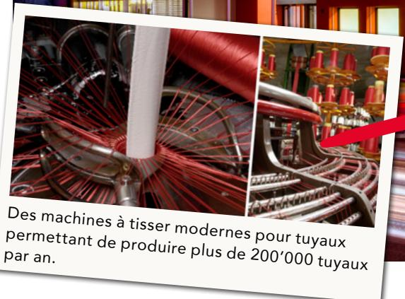
Des machines à tisser modernes pour tuyaux permettant de produire plus de 200'000 tuyaux par an.
