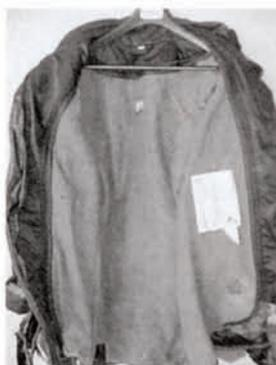
La doublure isolante (type Eybl) est intacte et répond aux critères de protection
