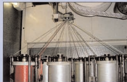
Le polyester blanc est la matière première servant à la fabrication des cordes de sauvetage!
