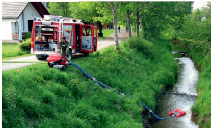
die Ansaugöffnung unter Wasser bleibt. Ein eingebautes Rückschlagventil in Form einer Klappe stellt sicher, dass die Saugleitung bei Unterbrechungen mit Wasser gefüllt bleiben.
