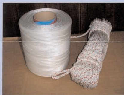
Rohstoff Polyester weiss aus welchem als Endprodukt die Rettungsleinen gefertigt werden!
