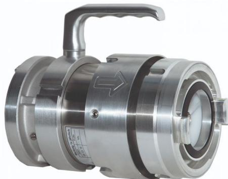
Séparateur de système mobile pour les sapeurs-pompiers afin de protéger le réseau d'alimentation en eau potable contre le refoulement, l'aspiration ou la contre-pression de l'eau d'extinction provenant de bouches d'incendie ou de tubes verticaux. Dispositif anti-retour du côté entrée et sortie, différence de pression à l'entrée d'eau au moins 0,14 bar, collecteur de pierres. La norme DIN 14346 définit clairement le séparateur de système B-FW mobile et ses caractéristiques.
